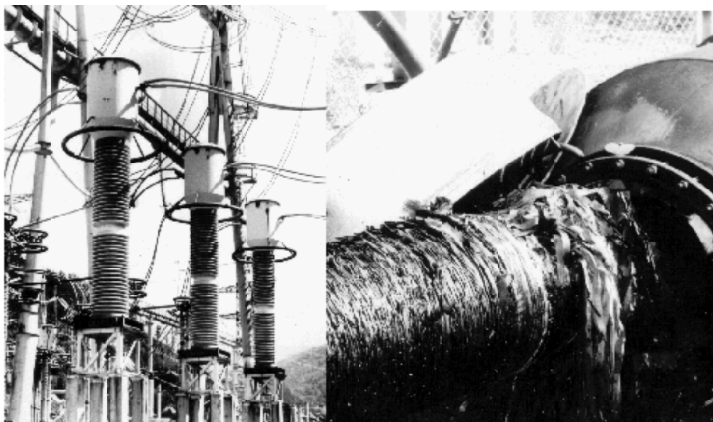
Рис. 6.15 а) – внешний вид ТФРМ-500; б) – разрушенный ТФРМ-500
