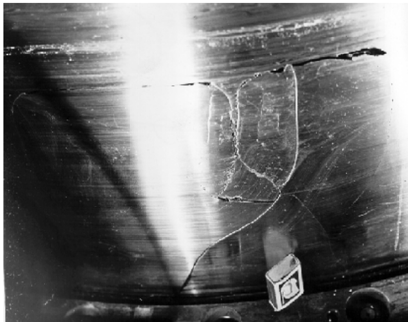
Рис. 3.16 Разрушение облицовки вала турбинного подшипника
