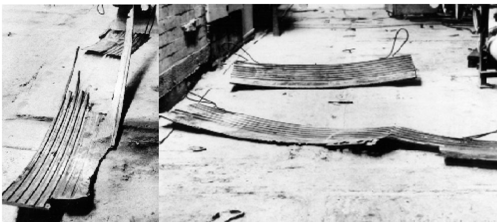
Рис. 3.14 Разрушение неподвижного лабиринтного уплотнения турбины
