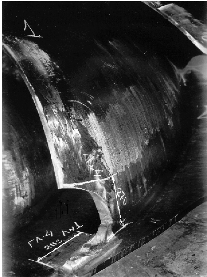
Рис. 3.25 Вылом части лопасти 265x270 мм на рабочем колесе агрегата № 4 после наработки 58067 часов
