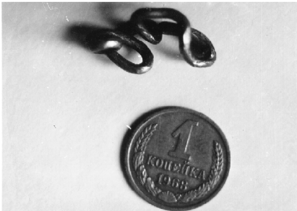
Рис. 4.27 Стальное кольцо, находившееся в обмотке статора, подвергшееся электромагнитным воздействиям
