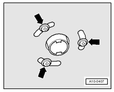
Освободить крепежные элементы -1 ... 4- и снять шумоизоляционные экраны.
