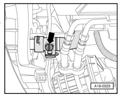
Дополнительно отсоединить водяной шланг от масляного радиатора -стрелкаи слить оставшуюся охлаждающую жидкость.
