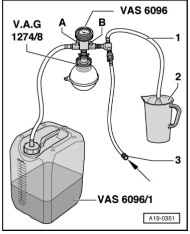
Открыть клапан -В-, для чего повернуть рычаг параллельно пропускному направлению.
