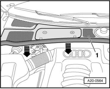
Снять передний кожух двигателя стрелки-.
